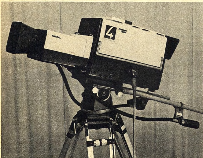
Bild 3. Die Fernseh GmbH zeigte in Chicago die mit drei Plumbicon-Röhren bestückte, voll transistorbestückte Farbkamera KCU 40, die u. a. wegen ihres extrem dünnen Kamerakabels (7 mm \phi ) Aufsehen erregte
