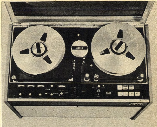
Bild 6. Studioltüchtiger Farbfernseh-Video-recorder, Typ IVC-900, mit Schrägspuraufzeichnung und vollständiger elektronischer Schneideeinrichtung
